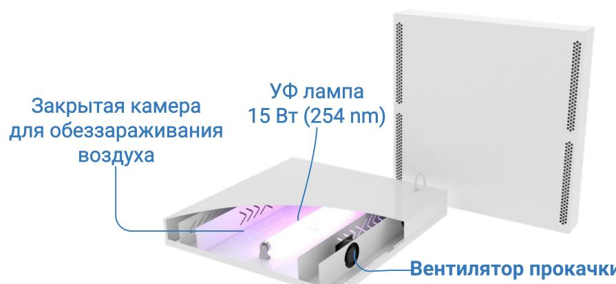
Принцип работы, заключается в захвате вентиляторами воздуха внутрь обеззараживающей камеры, где происходит его обеззараживание с помощью излучения бактерицидной лампы, после чего чистый воздух выходит наружу, а цикл повторяется заново.
